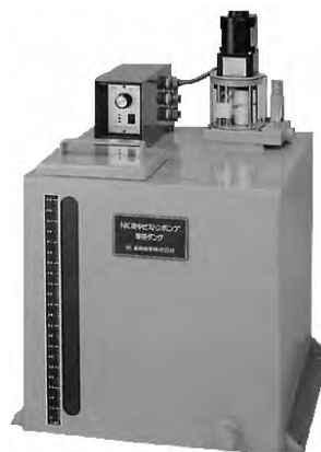
図3 次亜塩素酸ナトリウム注入装置の例 (ガス発生によるトラブルのない液中ポンプと貯留タンクが一体となっている)
